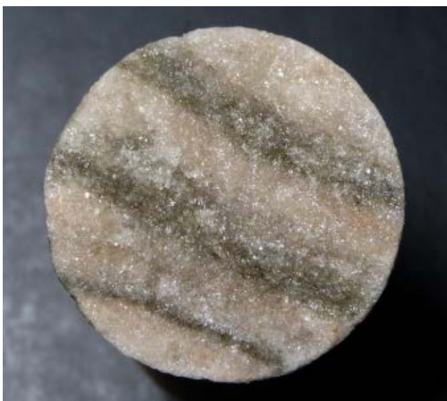
Abb. 1: Querschnitt eines Bohrkerns aus Salzstein, Durchmesser 4 cm. Das „Liniensalz“ zeigt, wie uneinheitlich die Zusammensetzung des Salzgesteins sein kann. (Foto: N. Kück)
