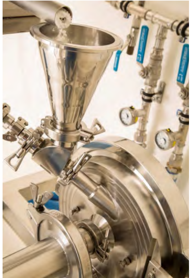
Abbildung 3: Detail der Rohstoffbeschickung vor einer Mühle (Foto: GfM)
