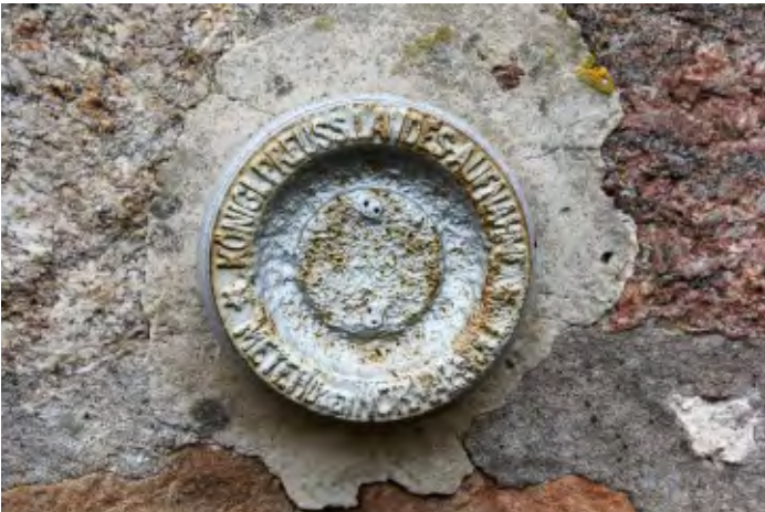
Abb. 3: Höhenmarke am Turm der Lesumer Kirche, die im Rahmen einer Messung im Jahr 1890 festgelegt und deren Höhe zu 22,956 m ü. N. N. bestimmt wurde (vgl. Abb. 5). Foto: M. Klemke.
