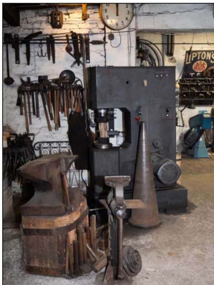
Schraubstock, Amboss, Hämmer, und Zangen, Lufthammer und Ringhorn. Voll ausgestatteter Arbeitsplatz zum Schmieden. (HVL-Archiv-Nr. F04186)
