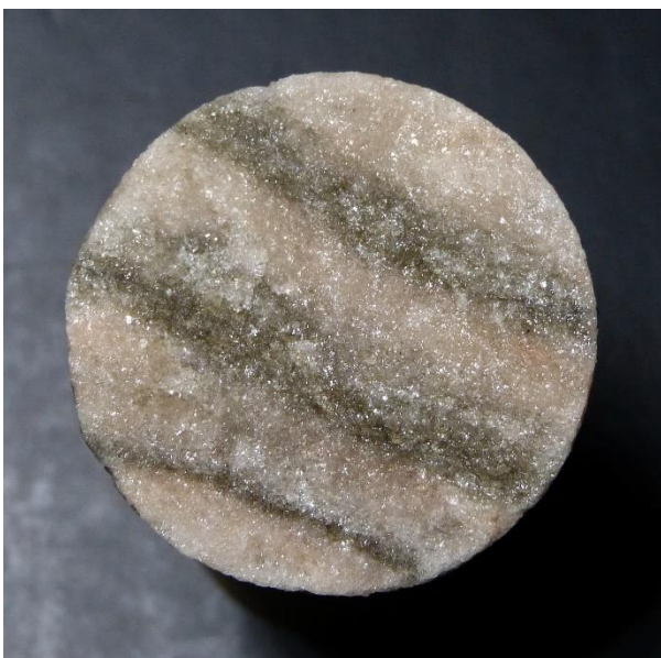
Abb. 1: Querschnitt eines Bohrkerns aus Salzstein, Durchmesser 4 cm. Das „Linien-salz“ zeigt, wie uneinheitlich die Zusammen-setzung des Salzgesteins sein kann.
